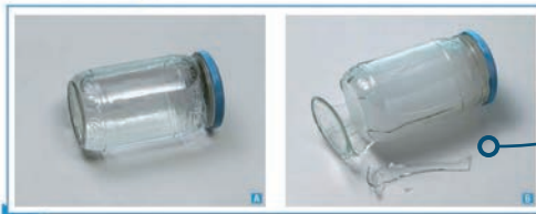
Doc. 1 Ce bocal en verre rempli d'eau a été mis au congélateur.
